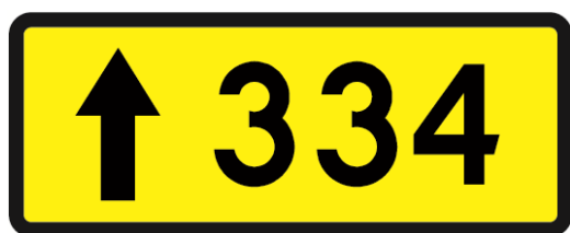
Rys. 6.3.7.12. Znak E-15b z numerem drogi wojewódzkiej ze strzałką kierunkową skierowaną na wprost
