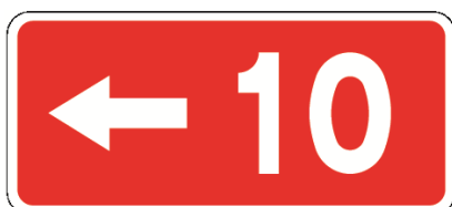
Rys. 6.3.7.11. Znak E-15a z numerem drogi krajowej ze strzałką kierunkową:
